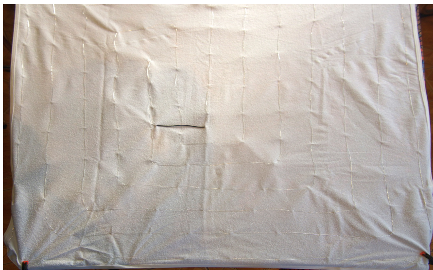
Matratzenschoner mit zusätzlich aufgebrachten Sensor-Drähten
