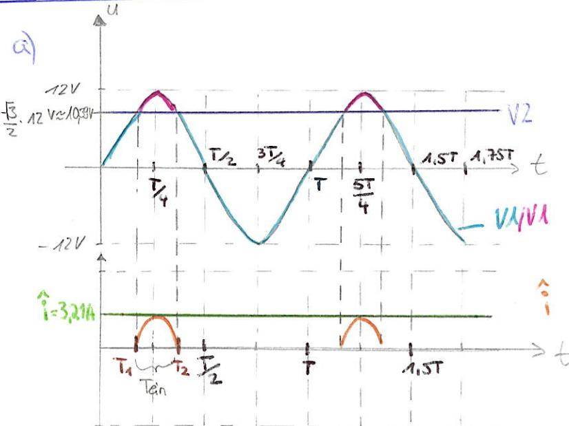
die Spannung  $V_1$  größer ist als  $10.39V$  (siehe leitenden Zustand in rosa). Ansonsten sperrt die Diode, da eine negative Spannung anliegen würde.
