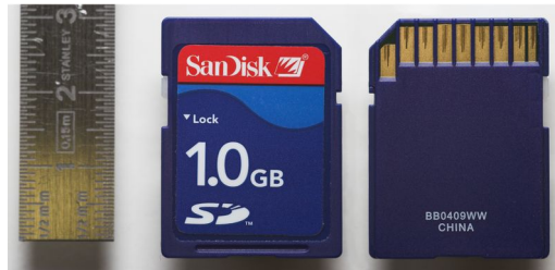
Abbildung 1: Vorder- und Rückseite einer SD-Karte.
