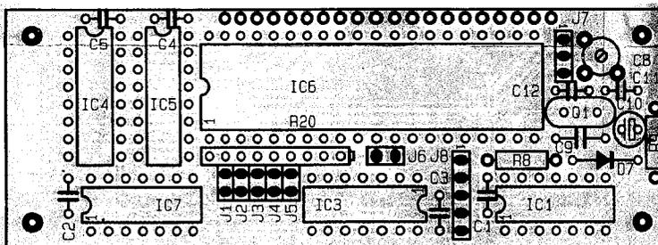
Der Zähler IC 4 zählt nun Oszillatorperioden und Zähler IC 5 Eingangssignalperioden. Da die Breite des Überlaufimpulses  $\overline{RCO}$  der beiden 8-Bit-Zähler nur die Breite eines Taktes hat und der Mikrocontroller dieses nicht verarbeiten kann, ist den Zählereingängen des Controllers je noch ein weiterer Teiler IC 7 vorgeschaltet, deren Ausgangssignale ein Tastverhältnis von 1 : 1 besitzen, wodurch der Controller die weitere Zählung übernehmen kann.
