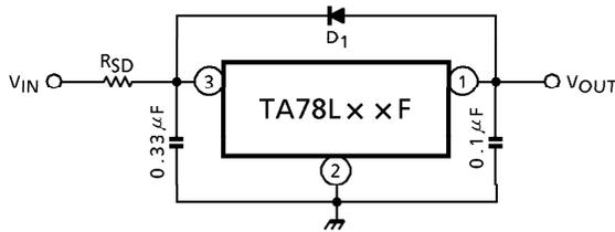
D<sub>1</sub> : IC protective diode
