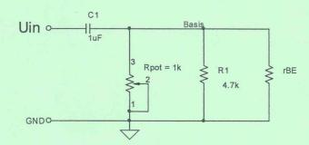
Bemerkung: wechselstrommässig stellen Spannungsquellen Kurzschlüsse dar!
