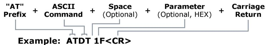
To read a parameter value stored in the RF module's register, omit the parameter field.
