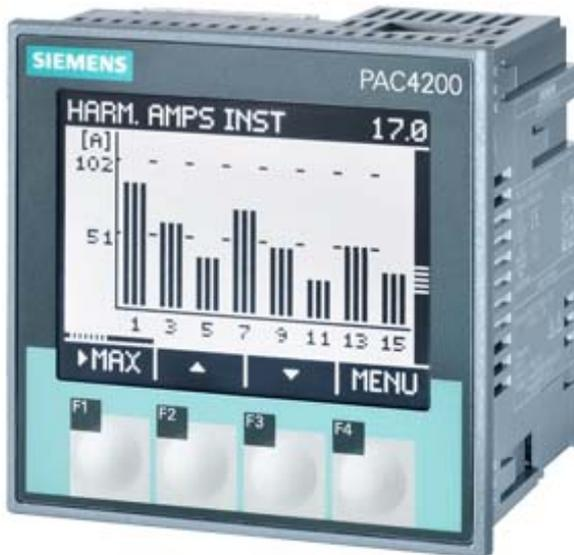
SETRON, Messgerät, 7KM PAC4200, LCD, L-L: 690 V, L-N: 400 V, 5 A, 3-phasig, Modbus TCP, optional Modbus RTU / PROFINET / PROFIBUS / DI/DO, Schein- / Wirk- / Blindenergie / cos phi, Oberschwingungen: 3. - 31., THD, Klasse 0,2 gem. IEC61557-12 bzw. Klasse 0,2S gem. IEC62053-22, Weitspannungsnetzteil, AC/DC, Schraubanschluss
