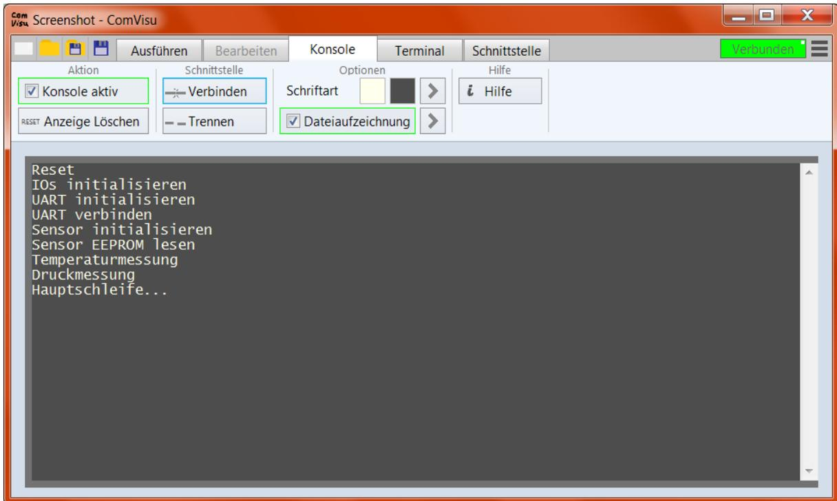
Zur Fehlersuche können im Terminal die eingehenden Zeichen angezeigt werden, es werden die daraus gefilterten Befehle aufgelistet und markiert, ob sie verarbeitet wurden, d.h. ob ein Instrument vom entsprechenden Kanal abhängt.
