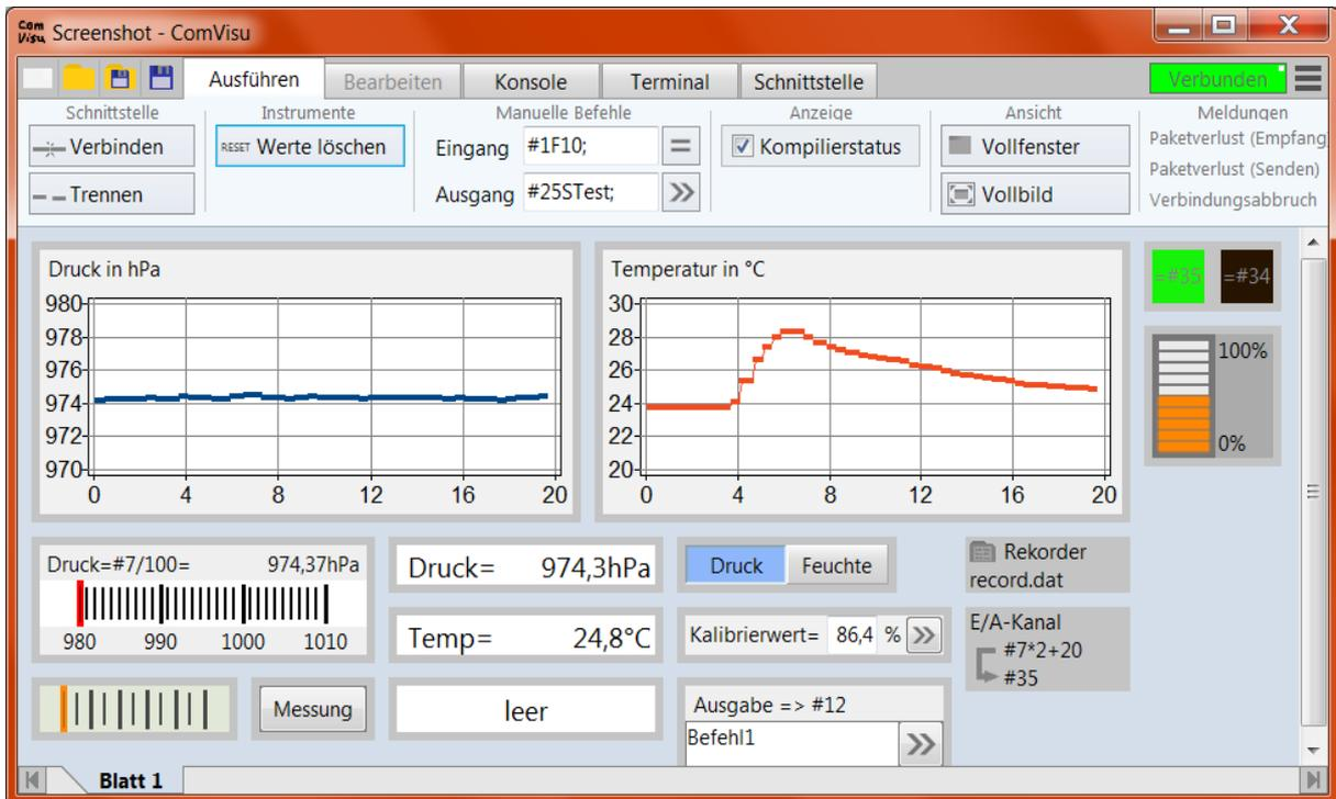
In der Bearbeitenoberfläche werden Instrumente platziert und konfiguriert. Das blau hinterlegte Feld Eingang (bzw. Ausgang) im Eigenschafteneditor legt den Kanal fest, das Aussehen der Anzeigen kann weitgehend dem eigenen Bedarf angepasst werden.
