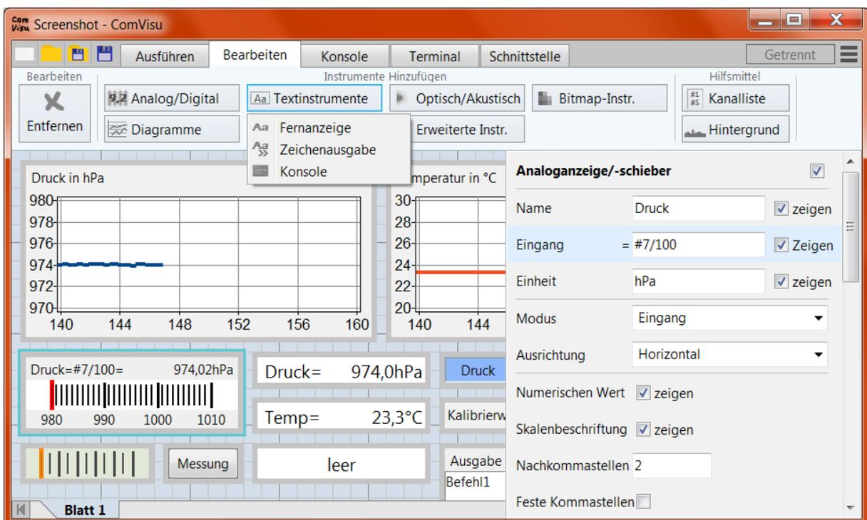
Auf der Konsole werden alle Werte und Zeichenketten angezeigt, die auf Kanal #0 eingehen. Für ein komfortables Debugging wie in einer Konsolenanwendung. "#0SEins\n;" führt zur Anzeige "Eins" mit anschließendem Zeilenumbruch.
