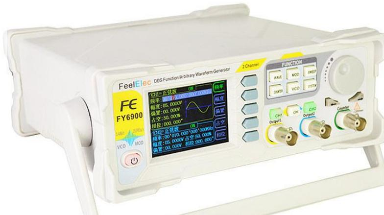
Originalzustand: Bei offenem Gehäuse Frequenzdrift Zeitbasis zwischen Zuschaltung und Endzustand ca. 13 ppm (-5,7ppm kalt – +7,4ppm warm / Referenz besser 0,5ppm).
