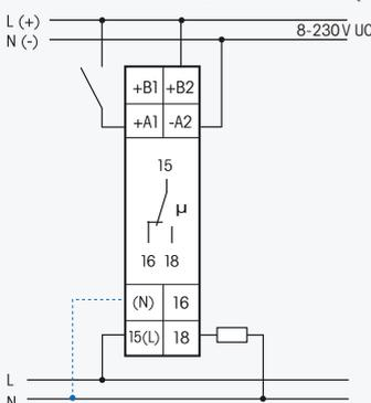
Bei angeschlossenem N ist die Kontaktschaltung im Nulldurchgang aktiv.
