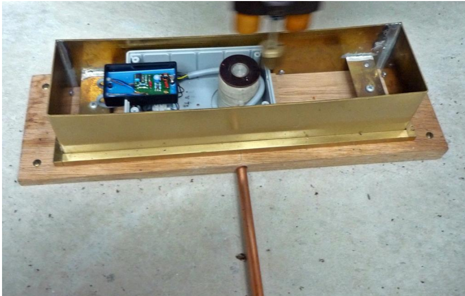
Bild:2.6.4: Spuleneinheit der Pendelsynchronisation (selbst erstelltes Foto)
