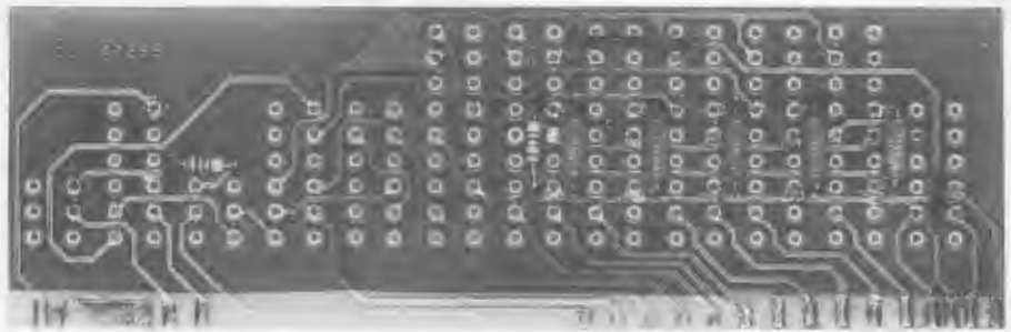
Ansicht der fertig bestückten Schalterplatine des 4,5-stelligen Digital-Multimeters DMM 7001 (Originalgröße: 50 mm x 155 mm)
