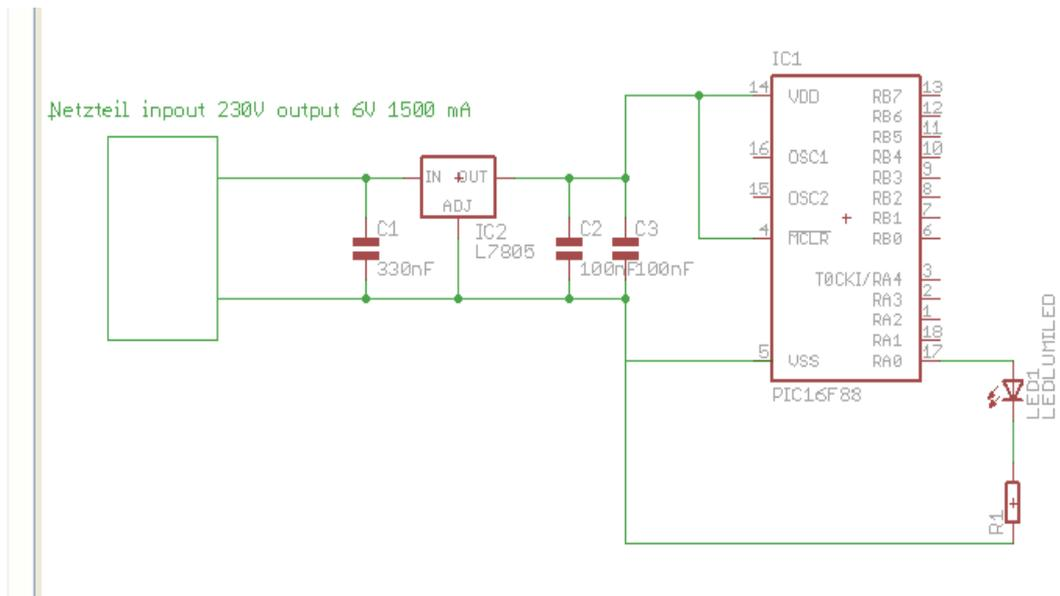
Wenn ich der Netzteil mit 9V Batterie ersetze Bilnkt der LED, Wenn nicht leuchtet er dauerhaft.
