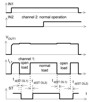
$t_{d(ST OL1)} = 30 \ \mu s \ typ., \ t_{d(ST OL2)} = 20 \ \mu s \ typ$
