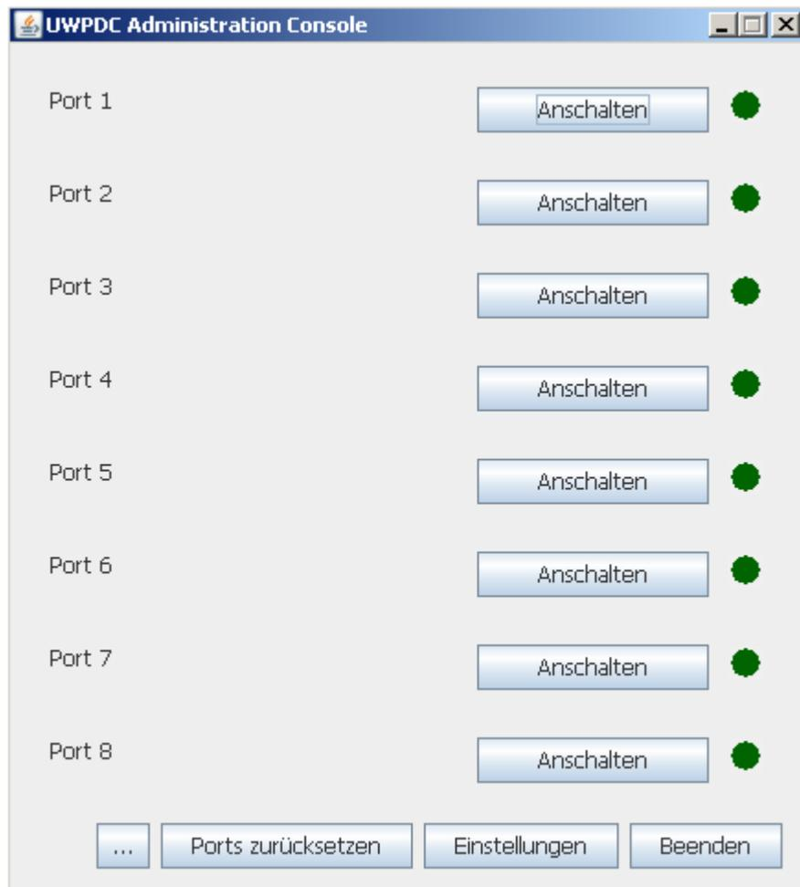
Alle Kanäle sind defaultmäßig auf AUS geschaltet, der Benutzer kann einzelne Kanäle durch Klick auf den „Anschalten“-Button einschalten. Die Kontrollleuchte des Ports wird dann aktiv, bzw. die Leitung erhält Strom. Beispielsweise geht die Nachtschlampe an.
