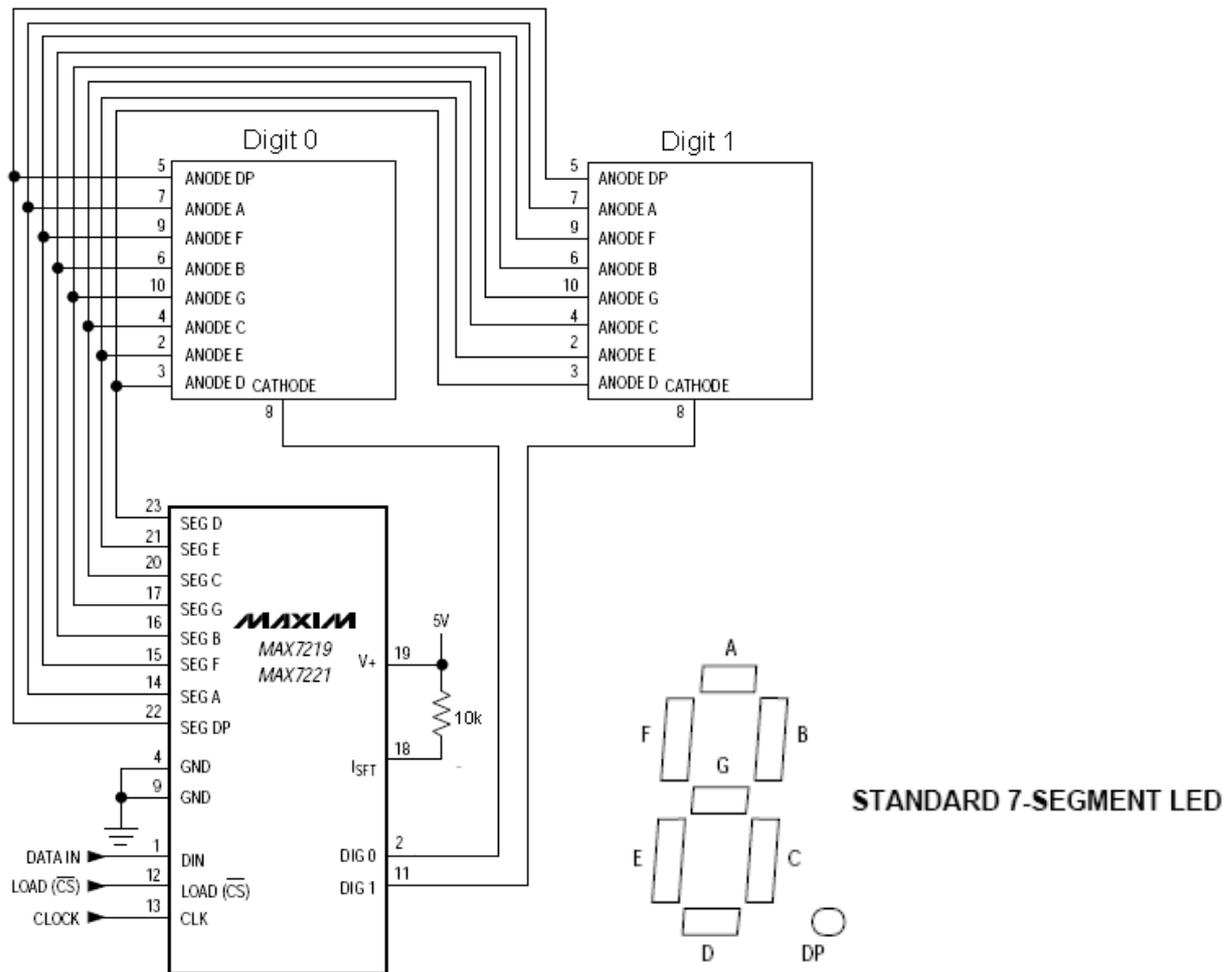
Die Kommunikation zwischen Mikrokontroller und MAX7219 erfolgt auf serieller Basis über 3 Leitungen.
