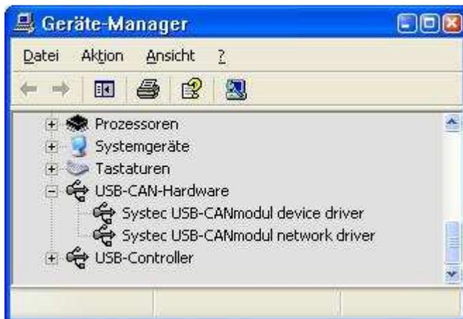
Bild 2: Geräte-Manager mit dem Eintrag USB-CANmodul (Windows 2000)
