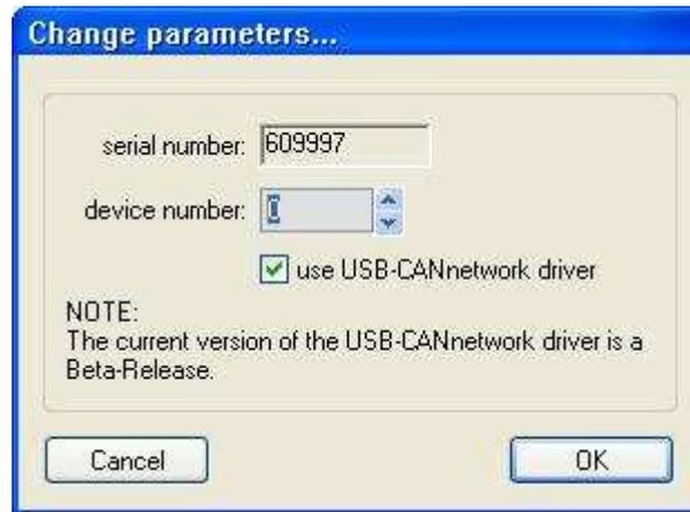
Bild 4: Dialogbox für die Einstellung der Gerätenummer
