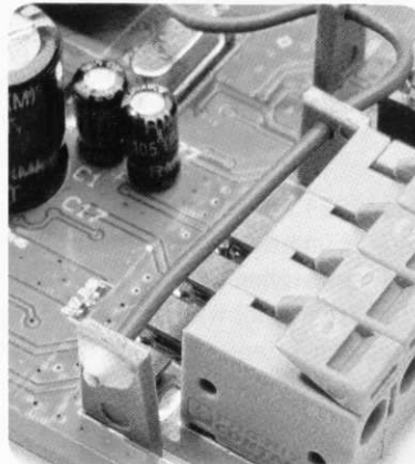
Bild 25: Das Ende der Funkantenne ist mit einem Tropfen Kleber zu fixieren.
