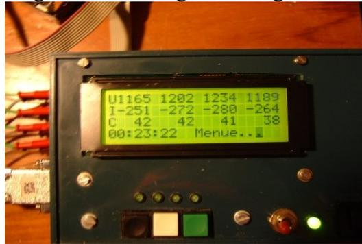
Die Werte aktivierter Akkukanäle werden auch über das UART an die serielle Schnittstelle ausgegeben, wenn die Ausgabe mit “monitor” auf der Kommandozeile des Terminalprogramms aktiviert wurde<sup>1</sup>. Die Ausgabe der Messwerte im Terminalprogramm erfolgt minütlich und sieht folgendermaßen aus (Kanal=1, Akku-Id N=1, Status S=2 entspricht Laden):
