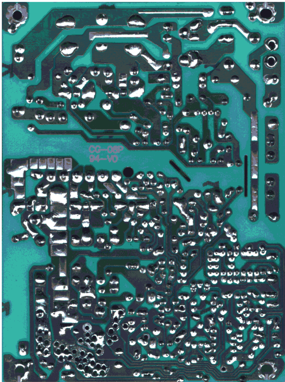
ATX Netzteil 350 Watt für INTEL Pentium IV und AMD Systeme, Lötseitenansicht der Leiterplatte:
