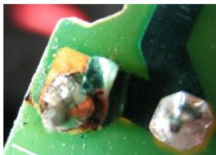
Abgelöste Leiterbahn an einem 230V-Anschluss
