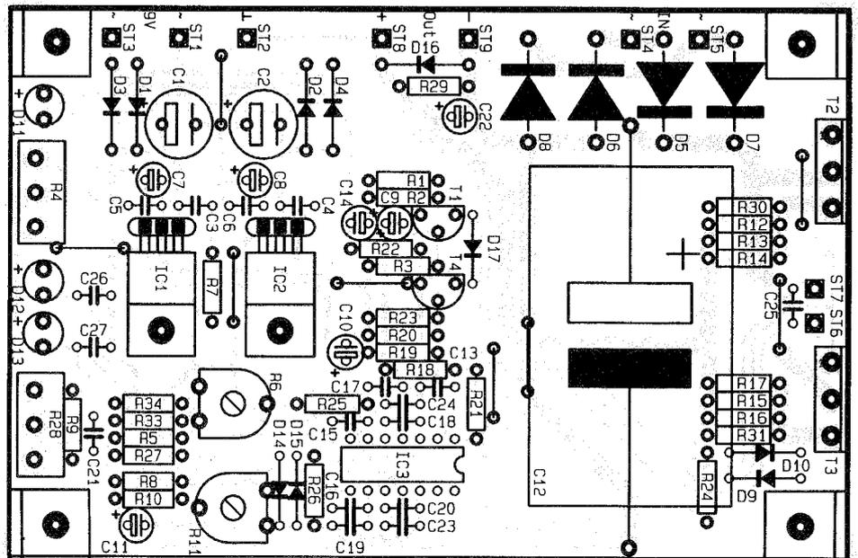
schon den Eingängen des Operationsverstärkers keine Spannungsdifferenz. Über den Widerstand R 9 fließt immer ein konstanter Strom, der über das Poti R 28 abfließt und einen Spannungsabfall erzeugt, der proportional zum eingestellten Widerstand ist und der Ausgangsspannung des Netzgerätes entspricht.
