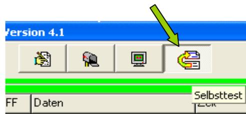
Bei fehlerfreiem Ablauf erscheinen nach dem Start im Empfangsfenster zur Bestätigung alle rückgelesenen (gesendete) Messages und in der 8.Zeile zusätzlich die TX-Buffer-Daten des  $\mu C$ 's (Zwischen-Buffer). Hiermit können Sie also den normalen Sende/Empfangs-Ablauf, die Remote Request-Funktion und den zyklischen Betrieb anschaulich ablaufen lassen. Zur genaueren Betrachtung sollten Sie die Funktionen "Senden", "Empfang" und "Anforderung eines Remote-Objekts" zu Hilfe nehmen.
