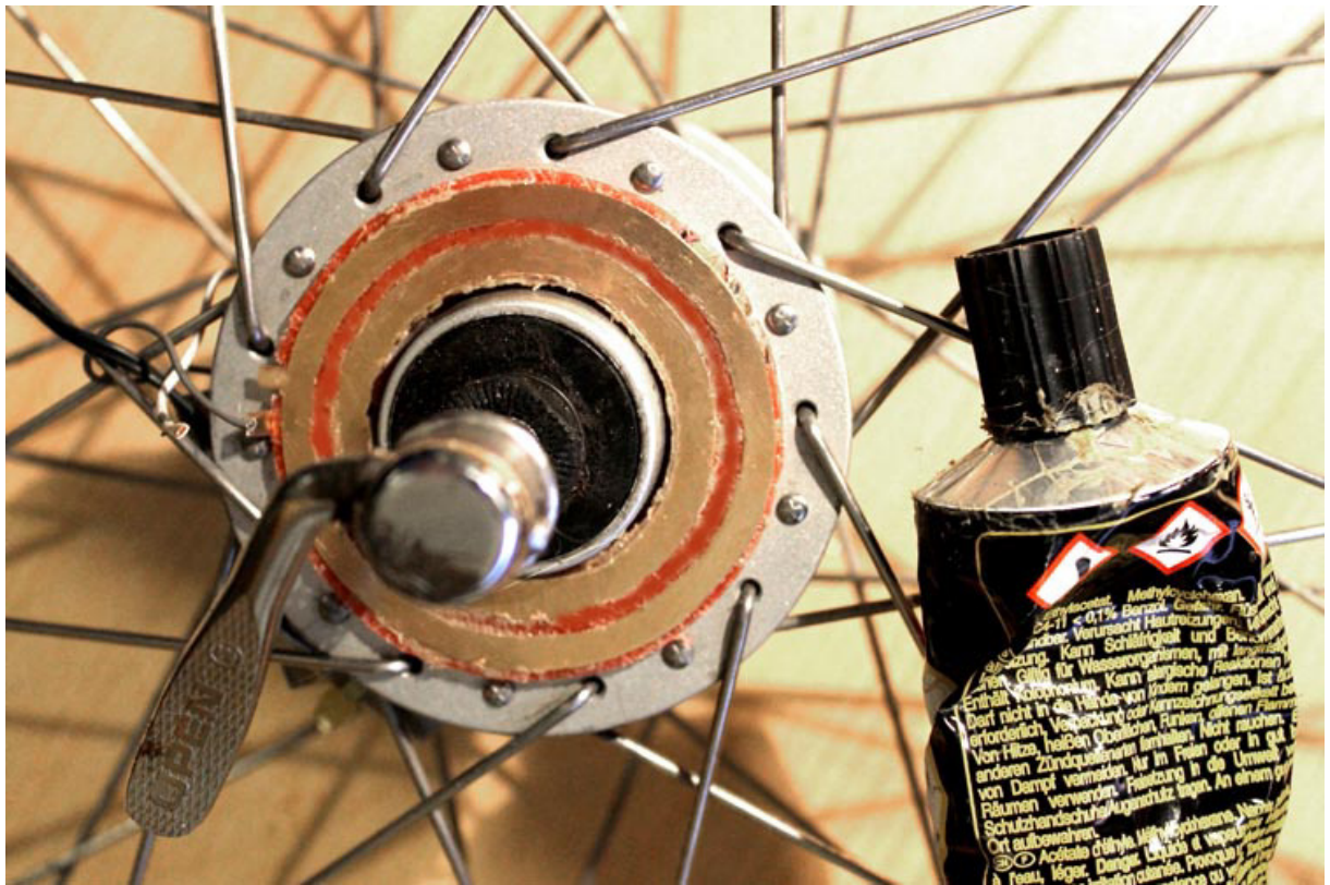
Schleifring auf Nabendynamo geklebt
