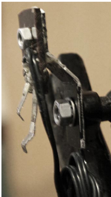
Schleifkontakte aus Bronze-Blech auf Kunststoffträger montiert oder Kohlebürsten
