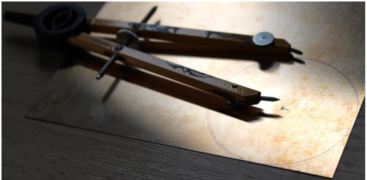
Messing-Blech, Ringe anzeichnen mit Zirkel
