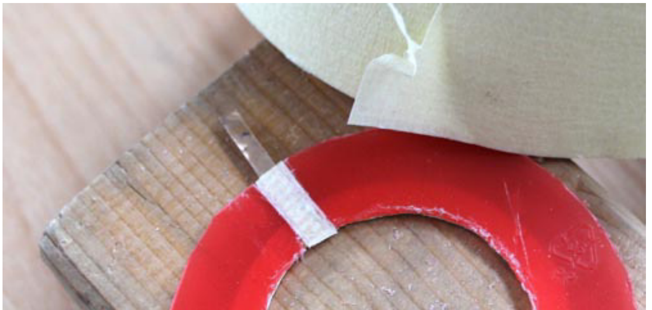
Kunststoffträger und innerer Bronzering, Kontaktfahne in Kerbe isoliert
