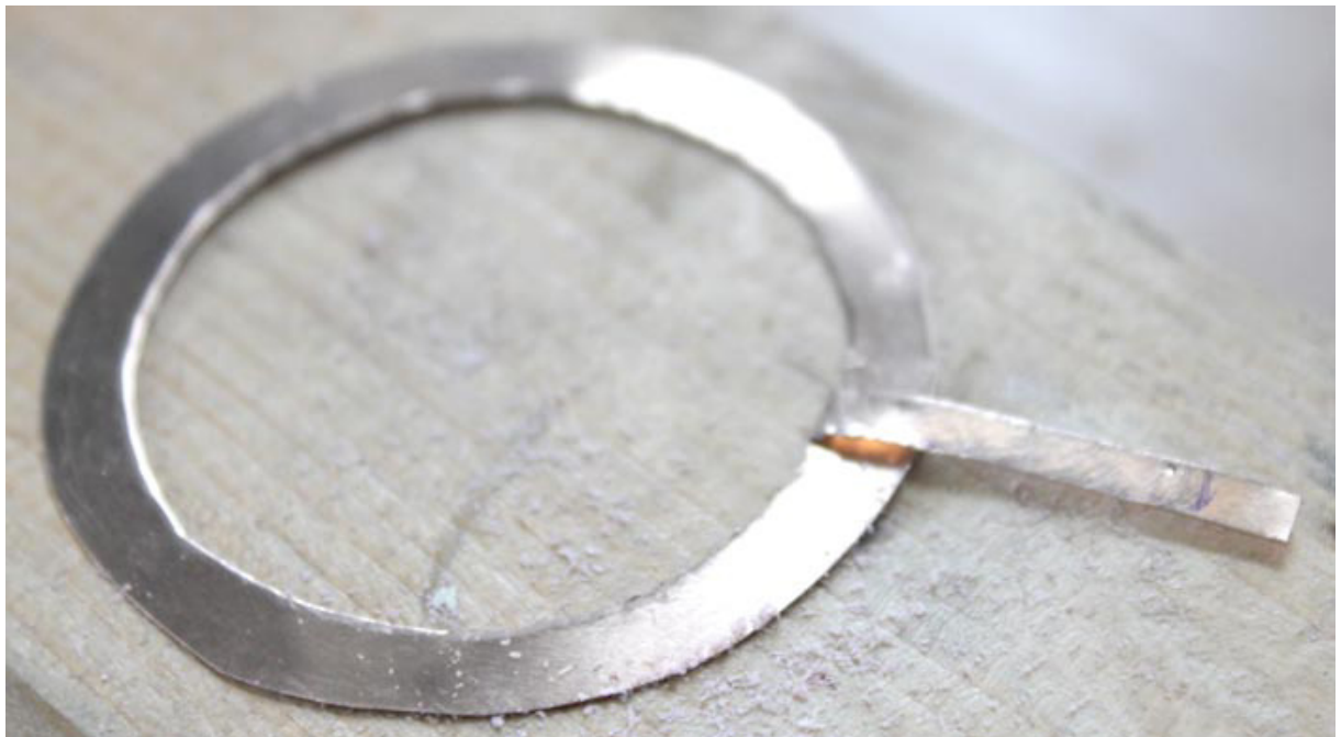
innerer Bronze-Ring, Kontaktfahne nach außen gebogen
