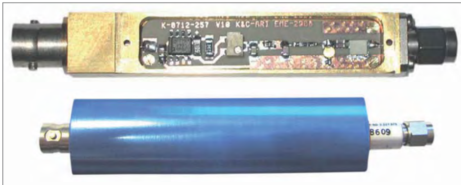
Bild 6b: Die bestückte Leiterplatte fertig eingebaut in das Fräsgehäuse; darunter das „Endprodukt“ mit externem Dämpfungslid (rechts)
