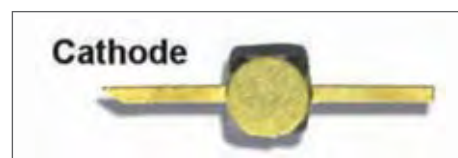
Bild 1: Rauschdiode Typ NS-303 im vergoldeten Metall-Keramik-Gehäuse; Frequenzbereich: 10 Hz - 8 GHz (max. 10 GHz) Ausgangspegel: ca. 30 dBENR, BIAS: 8 - 10 mA (8 - 12 V)
