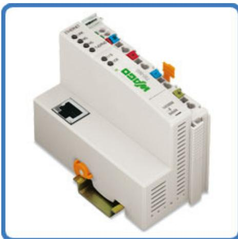
Das Herz des Controllers bildet ein 32-Bit-Prozessor mit einer Taktfrequenz von 44 MHz. Der Speicherausbau setzt sich aus 16 MB RAM, 32 kB NOVRAM und einem 4 MB großen Flash-Speicher zusammen. Im Flash-Speicher ist ein 2,5 MB großes JFFS2-Dateisystem untergebracht. Eine integrierte Echtzeituhr (RTC) rundet das Leistungsspektrum ab.
