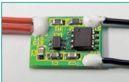
Bild 3: Sicherung der Leitungsanschlüsse durch zusätzlichen Klebstoff
