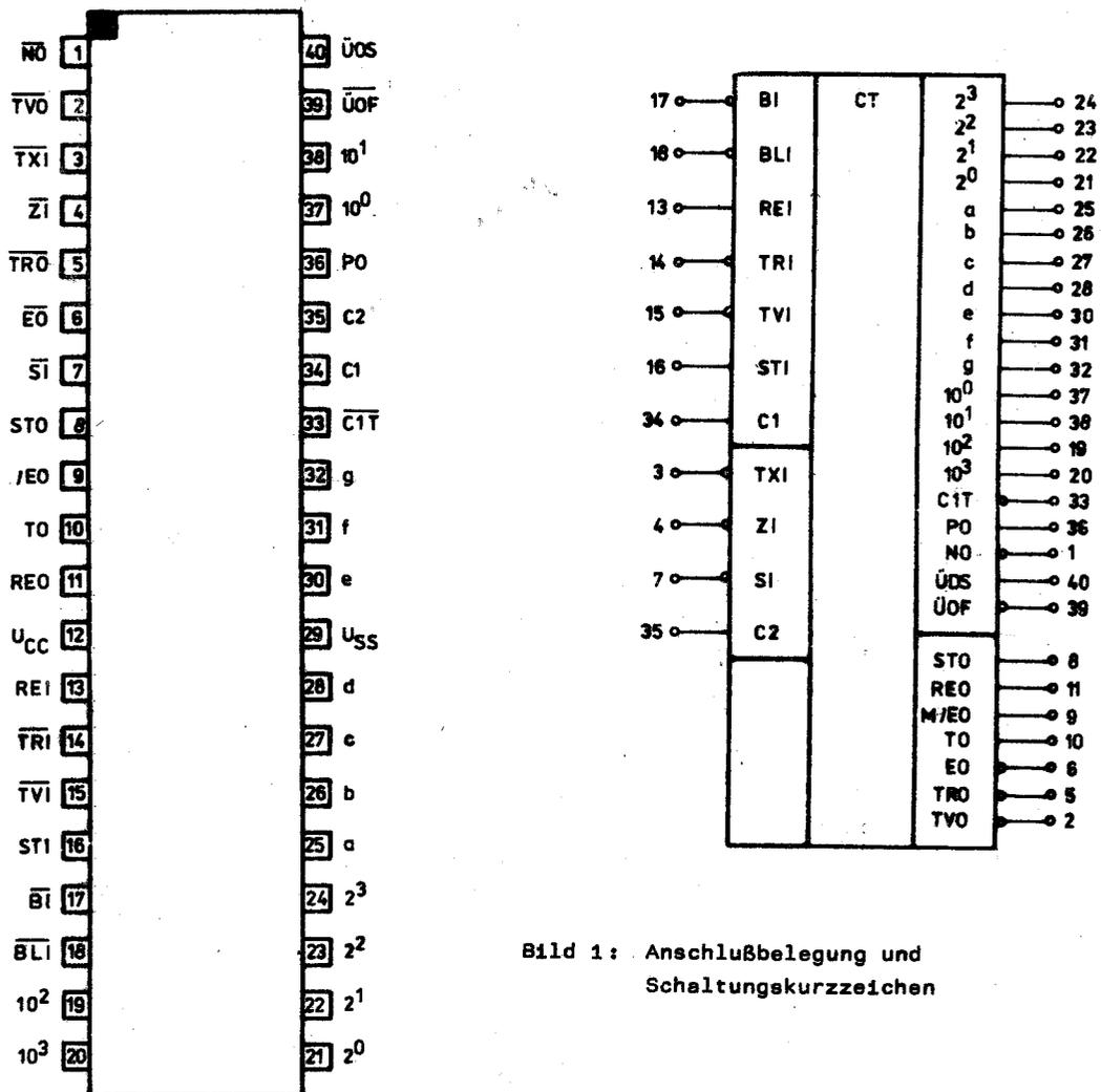
Bild 1: Anschlußbelegung und Schaltungskurzzeichen
