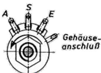
Beim Drehen der Einstellachse nach rechts (im Uhrzeigersinn) erhöht sich der Widerstandswert der Widerstandsstrecke zwischen Ende und Schleiferkontakt.
