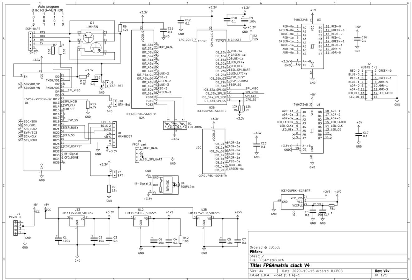
Bei diesem Design wurde auf ein FPGA-Configuration Flash-ROM verzichtet. Das FPGA wird beim Start über die SPI-Schnittstelle mit einer entsprechenden Konfiguration versorgt und dann gestartet.
