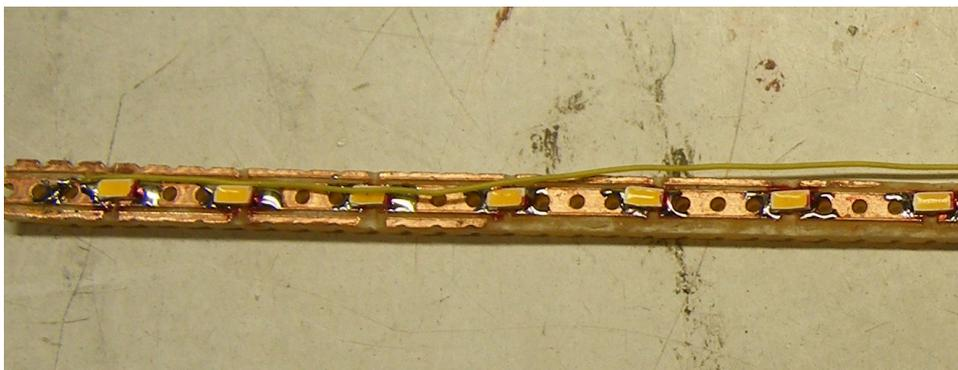
Pro Seite 14 Stück, 7 LEDs in Reihe Plus in der Mitte Minus links und rechts mit einen dünnen Draht verbunden. Die Drähte oben und unten an die LEDs vorbei führen eventuell mit etwas Tesafilm fixieren.
