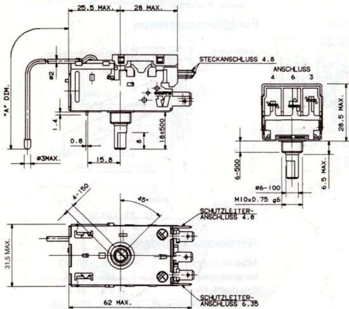
Regler in Stellung KALT dargestellt, entspricht Standardausführung, andere Drehwellenposition auf Wunsch. Bei Ausführung in Steckanschluß 6,3 mm sind Anschlüsse 4 + 3 um 90° zu o. a. Abbildung gedreht.
