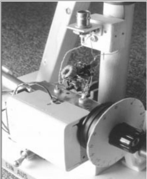
Abbildung 8: Drehkondensator mit angeschlossenem Puffer und BNC-Ausgangsbuchse
