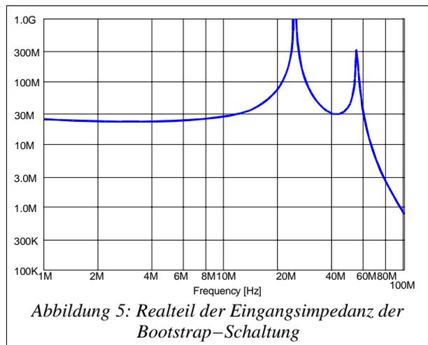
Das Ergebnis dieser Schaltungskniffe kann sich aber sehen lassen, denn der Realteil der Eingangsimpedanz liegt bis über 60 MHz deutlich über 10 MOhm. Zum Vergleich: mit den oft gezeigten einfachen Sourcefolgern erreicht man kaum Werte von 100 KOhm bis 10 MHz. Die Verstärkung dieser Schaltung ist mit einem 3:1 Übertrager am Ausgang bis zu 300 MHz nahe an 1.
