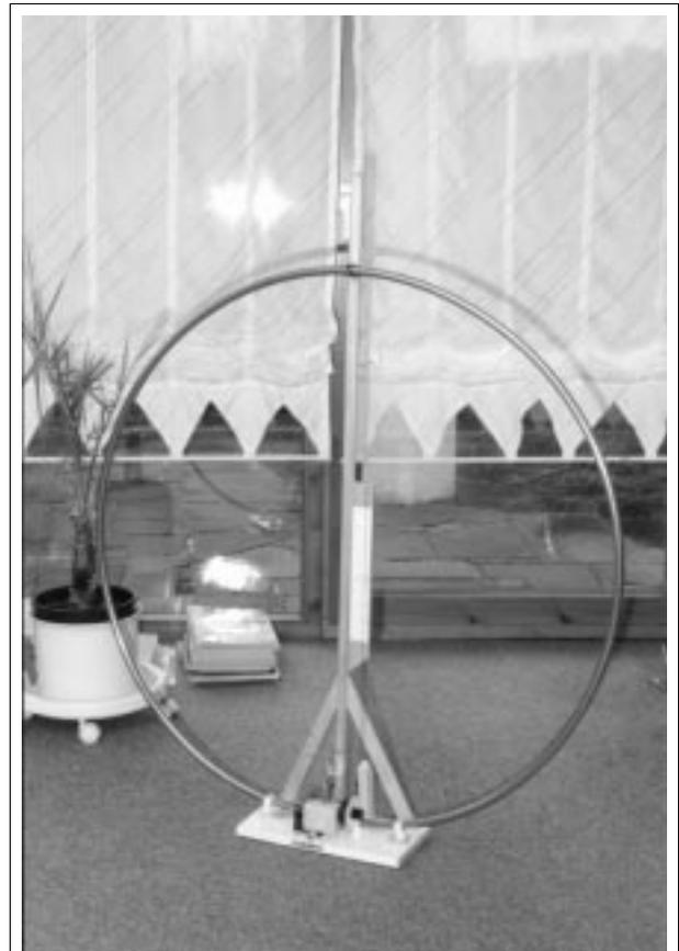
Abbildung 7: Die Antenne mit einem Besenstiel als »Mast« und einer Schnurskala
