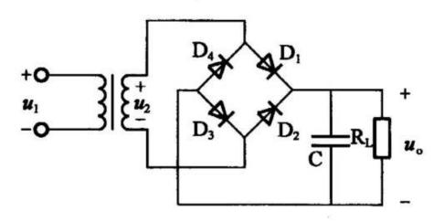
Figure10. Bridge rectifier circuit
