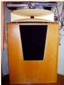
□ Das getunte Klipschorn des Vaters besitzt nun vier statt dreier Wege. Auch hier arbeitet oben ein Coral-Horn, das Mitteltonhorn wird von einem ACR-Treiber befeuert. Den Tiefmittelton unterstützen zwei Beyma 8M100, während sich der 15G200 im Inneren des Horns vergnügen darf. Offensichtlich sehr zufrieden mit seiner „High End – High Power“-Anlage, beschreibt Herr Eichinger das über 20 Jahre alte Horn als „besser als manche teure High-End-Box“
