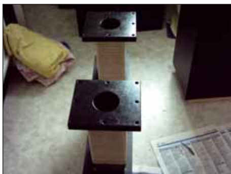
Die Bassreflexrohre (wenn man von Rohren sprechen will) bestehen aus schichtweise aufgebautem MDF
