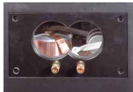
Durch ein Plexiglas-Fenster im Deckel des Weichenfachs sind die sehr hochwertigen Bauteile der Bassreflexbox zu erspähen
