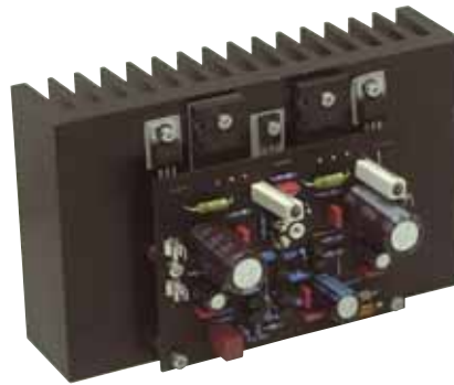
Die fertig aufgebaute Verstärkerplatine, bereits auf dem Kühlkörper montiert
