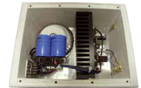
Ein Monoblock komplett aufgebaut und verkabelt. Hier fehlt nur noch die Deckplatte
