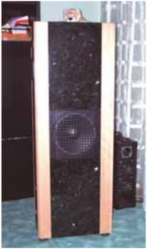
□ Rudolf Müller aus Köln baute sich dieses Paar monumentaler Boxen nach dem Vorbild der „Votum Starlit“. Die Bestückung entspricht dem Original, das Gehäuse ist entgegen dem Ursprung aus Holz und echtem, hochglanzpoliertem Granit aufgebaut
