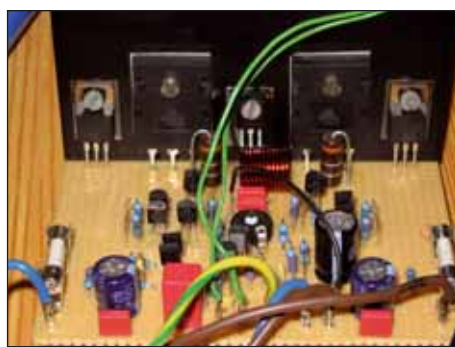
So hat's angefangen mit dem aktuellen SymAsym bei Michael Bittner – auf einer Lochrasterplatine
