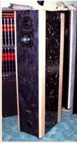
□ Rudolf Müller aus Köln baute sich dieses Paar monumentaler Boxen nach dem Vorbild der „Votum Starlit“. Die Bestückung entspricht dem Original, das Gehäuse ist entgegen dem Ursprung aus Holz und echtem, hochglanzpoliertem Granit aufgebaut
