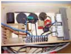
□ Entsprechend dem Credo „hochbelastbar und verlustarm“ sind auch die Frequenzweichen der Familienboxen mit großen Bauteilen und dicker, massiver Verdrahtung versehen. Die abgebildete Weiche ist allerdings nicht die der „kleinen“ Boxen, sondern gehört zum Klipschorn auf den folgenden Bildern
