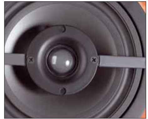
Selfmade-Koax: bei der Ton!Kugel sitzt der DT-25N auf einer Metallschiene direkt vor der Membran des SPH-170
