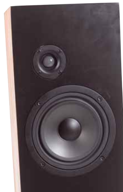
Der Hochtöner der Monalina sitzt außermittig, um den frequenzgangverbiegenden Effekt der Gehäusekanten zu verschmieren
