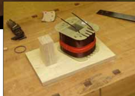
Das Ausgangsmaterial: die 5,6-mH-Spule mit 3 mm Drahtstärke (über 8 kg!) und ein Multiplexbrett mit angeschraubtem Träger. Die Bretter werden später mit Weiche in der Box verschraubt
