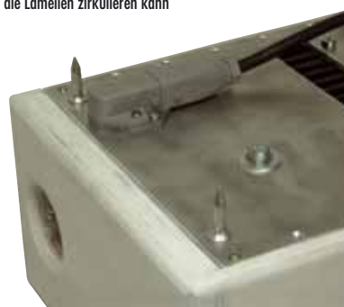
Das Netzkabel muss nicht quer durchs Gehäuse – diese Steckverbindung erlaubt eine deutlich geschicktere Platzierung des Netzeingangs
