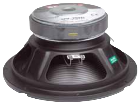
Großer Magnet, tiefgezogene Polplatte, Polkernbohrung – der Monacor SPH-250 TC ist ein kräftiger Subwoofer-Treiber alter Schule
