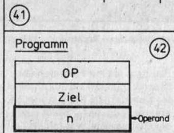
werden. Der Befehl **add 7, #3** (Maschinencode 06 07 03) erhöht den Inhalt von Register 7 um drei Zählsschritte. Wie schon zu sehen war, müssen in der Assemblersprache alle von der Adressierungsweise R oder RR abweichenden Operanden mit einem vorangestellten Zeichen gekennzeichnet werden (Abb. 35). Auch hexadezimale Zahlenangaben benötigen zum Unterscheiden vom Dezimalen solch einen Präfix. Hier nun eine Zusammenstellung der verwendeten Zeichen:
