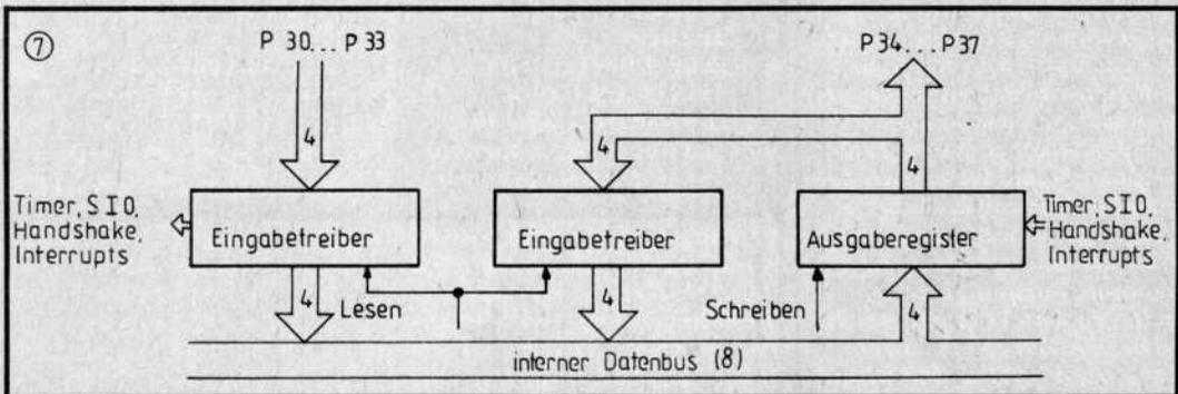
der Zeitgeber (Timer), des Serieninterface (SIO), der Handshake-Steuerung oder der Speicherverwaltung erfüllen. In diesen Fällen wird die ins Ausgaberegister eingetragene Information an den Pins nicht wirksam. Der Programmierer wählt mit dem Laden von Steuerregistern, ob P34 bis P37 als normale Ausgänge, die den Inhalt des Registers mit der Adresse 3 (%03) widerspiegeln, oder mit spezieller Funktion arbeiten.
