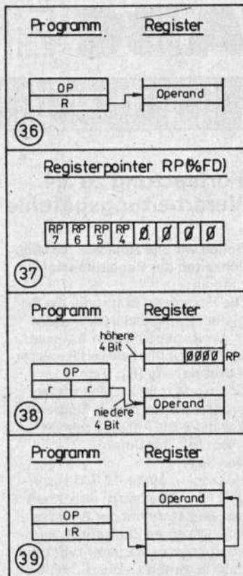
Hier enthält ein Arbeitsregister die Adresse des Operanden, der selbst nicht in einem Arbeitsregister stehen muß. So kann wegen des frei wählbaren Arbeitsregister-Inhalts mit lr ein Operand an beliebiger Stelle im Registerbereich trotz nur vier Adreßbits im Maschinencode spezifiziert werden. Natürlich muß die Anwendung dieses Mechanismus mit Voreinstellen von RP und des vermittelnden Arbeitsregisters vorbereitet werden.
