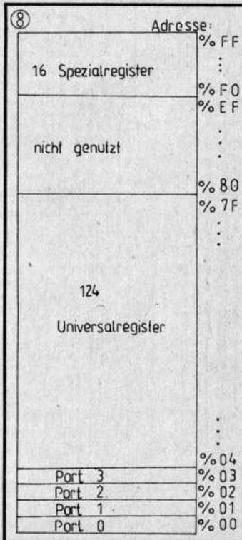
das Port 3 also dadurch, daß es nur vier Flipflops besitzt und mit den Anschlußstiften P30 bis P37 sowie verschiedenen Baugruppen verbunden ist.
