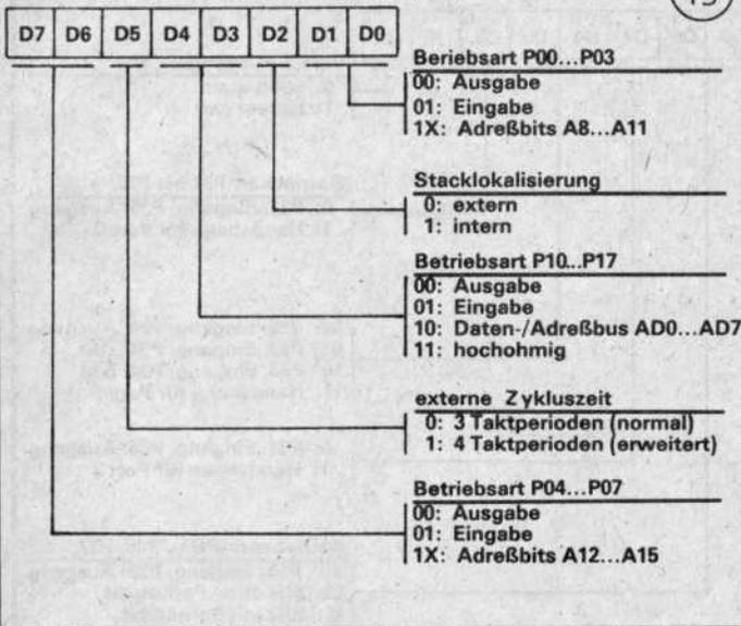
3-Signalaare sind normale Ein- bzw. Ausgänge, nur P34 dient als DM. Die Bits 3 und 4 könnten auch mit 10 belegt werden. Für die Ausgänge von Port 2 bewirkt die Belegung des P3M aktive Pull-up-Transistoren. P2M: 0000 0000 = %00 (vgl. Abb. 12)
