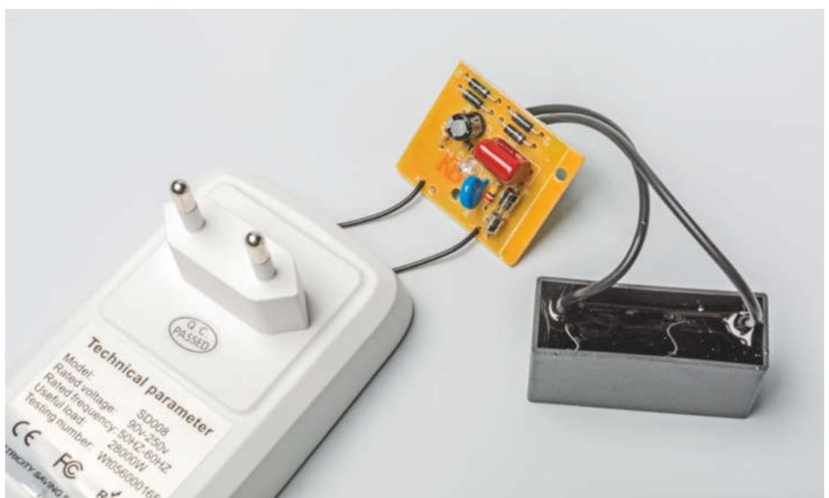
Im Voltbox-Gehäuse sitzt eine kleine Platine mit wenigen Bauteilen sowie als „Filterelement“ ein großer schwarzer Klotz, eine Blackbox im Wortsinn.
