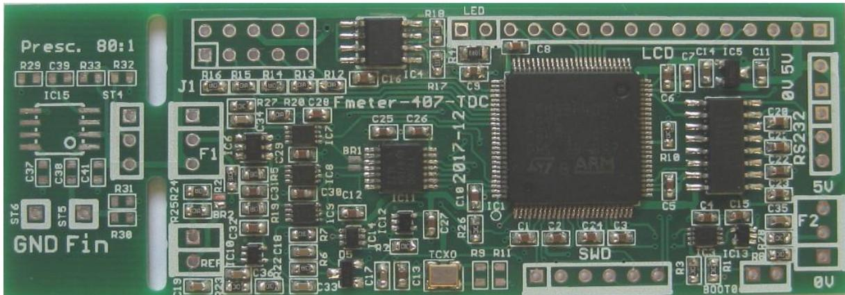
Der Vorteiler arbeitet im Frequenzbereich 10 MHz – 1,5 GHz und teilt die Eingangsfrequenz 80:1, sodaß die Ausgangsfrequenz etwa im Bereich 120 kHz – 19 MHz liegt. Passend zum verwendeten Eingang muß der Teilungsfaktor 80 eingestellt werden.
