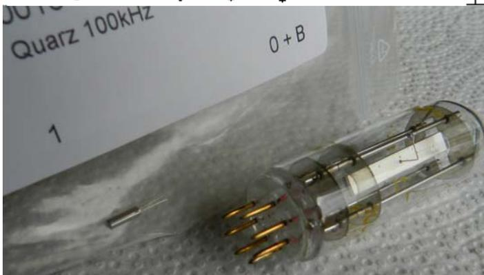
Die „Röhre“ ist der Original-Quartz 100,000 kHz.
