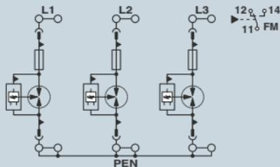
Innenschaltbild eines T1-Ableiters mit integrierter Vorsicherung
