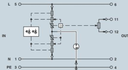
Innenschaltbild eines T3-Ableiters mit integrierter Versicherung
