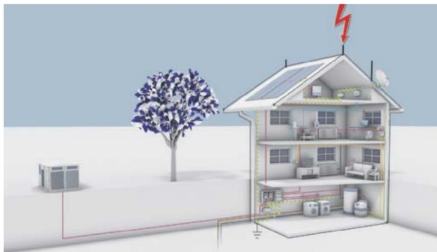
Alle Leitungen, die am zentralen Potenzialausgleich angeschlossen sind, werden mit dieser Spannung beaufschlagt. An blitzstromdurchflossenen Leitern entsteht zusätzlich eine Überspannung. Sie ist aufgrund der großen Stromsteilheit hauptsächlich auf den induktiven Anteil des Leitungswiderstands zurückzuführen. Nach dem Induktionsgesetz kann sie wie folgt berechnet werden:
