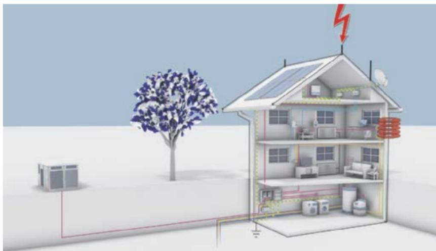
seinem Wirkungsbereich befinden, wie in die Sekundärwicklung eines Transformators. Über den Leitungsweg gelangt die eingekoppelte Überspannung in das angeschlossene Gerät.
