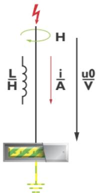
Entstehung von Induktionsspannungen in Leitungen
