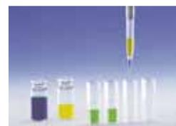
**Dilutieren (dd):** zwei Lösungen werden separat, getrennt durch ein Luftpolster, aufgenommen und zusammen abgegeben = Verdünnungsreihen (exkl. 1200 µl)
