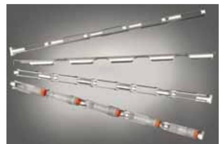
Aluminiumständer zur Aufbewahrung von bis zu 5 Röhrcchen der Größen 1,2 ml und / oder 2,0 ml in Dewar Gefäßen, N<sub>2</sub>-Kühlsystemen und Cryo-Truhen.
