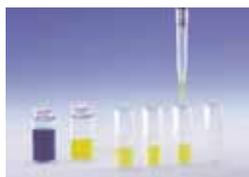
**Reverses Pipettieren (rP):** Aufnahme eines Volumens im Überschuss, Abgabe des eingestellten Volumens ohne Blow Out (exkl. 5000 und 1000 µl)
