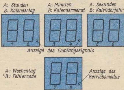
Bild 3: Anordnung und Bedeutung der Anzeigeelemente
