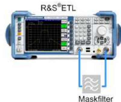
Abb. 8-5: Verkabelung zum Vermessen des Frequenzgangs eines Maskfilters
