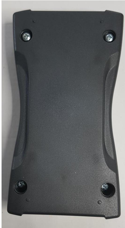
1. Das Gehäuse an der Rückseite durch Entfernen der vier Schrauben öffnen
