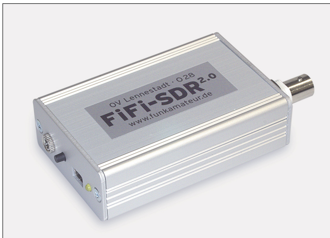
Bild 1: Vollständig aufgebauter FiFi-SDR-Empfänger
