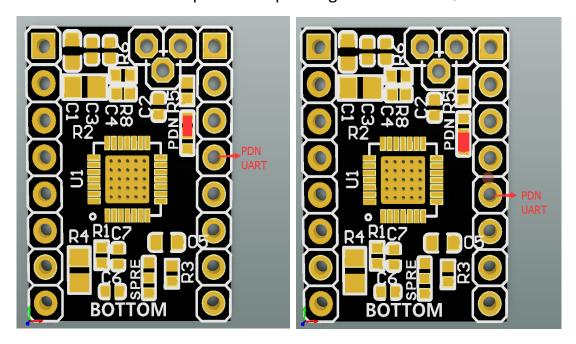
8.2. UART mode wiring diagram
