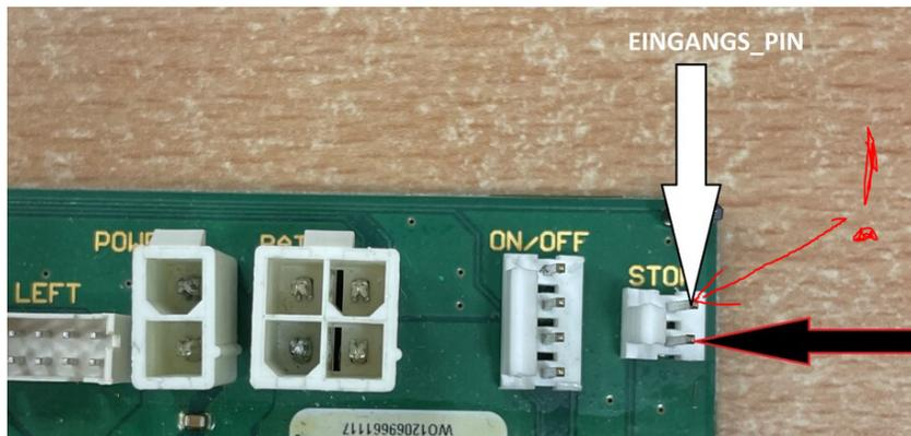
TEST: STOP Taste am Mäher drücken, Modul schaltet status auf den PIN durch und Mäher erkennt offene bzw geschlossene Klappe wieder richtig.
