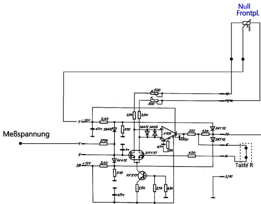
Die Meßspannung wird 1:1 "durchgereicht", der Eingangswiderstand an 1 ist jedoch sehr hoch (1 GOhm)
