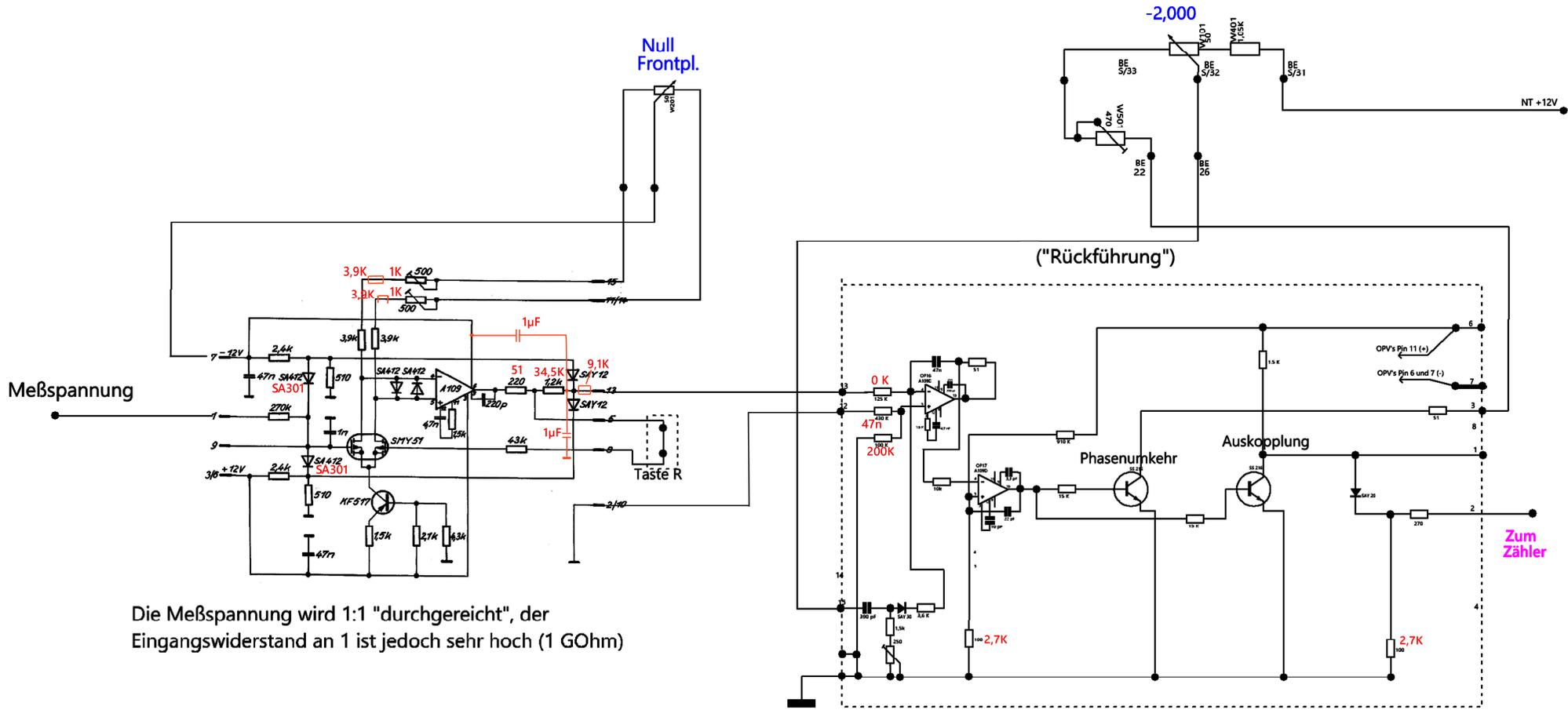
Die Meßspannung wird 1:1 "durchgereicht", der Eingangswiderstand an 1 ist jedoch sehr hoch (1 GOhm)
